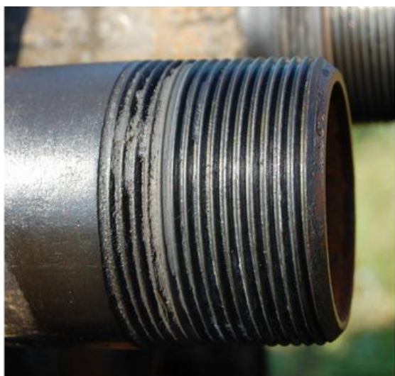
Рис. 4. Внешний вид поверхности НКТ после промышленных испытаний в газлифтной нефтяной скважине в течение 5 лет и 5 месяцев
